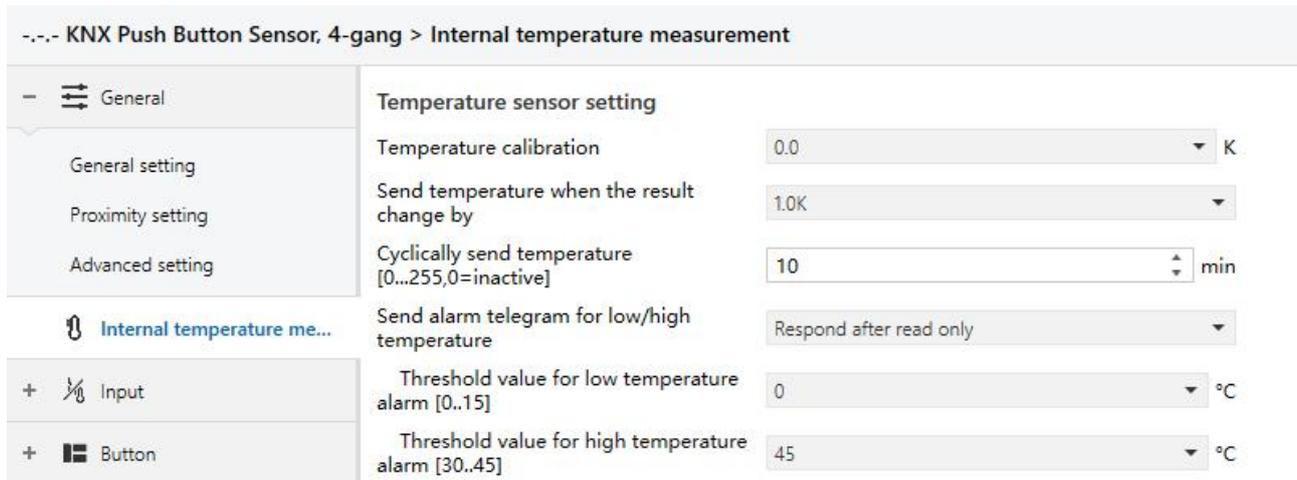
图 5.2 “Internal temperature measurement” 参数设置界面
