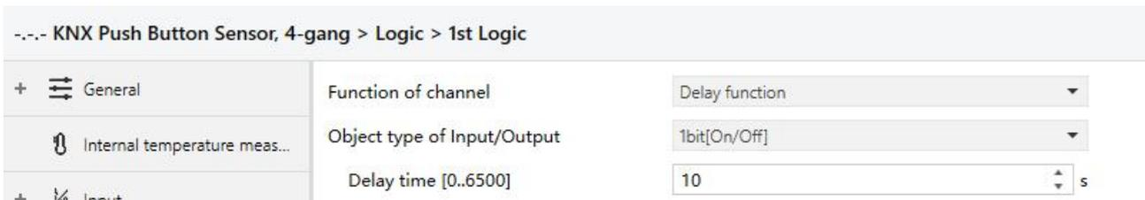
图 5.6.6 “Delay function” 功能参数
