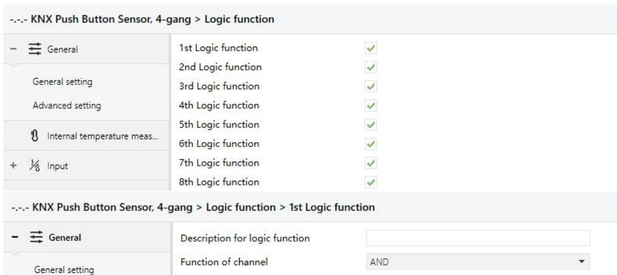
图 5.6 “Logic function setting” 参数设置界面
