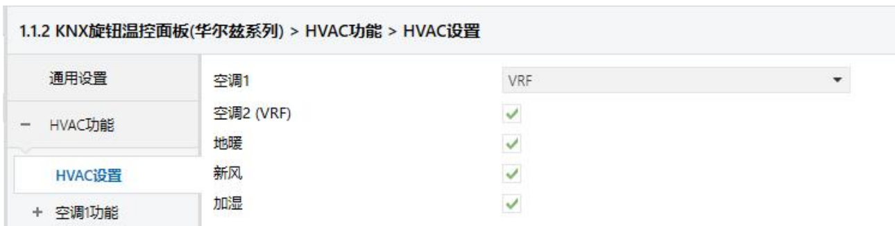
图 5.2 “HVAC 功能” 参数设置界面
